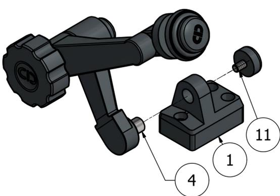
1- Retire el tornillo (8) y el eje de brazo (4).
